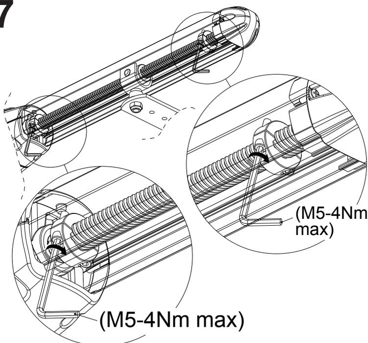
Fissare ora le viti degli arresti meccanici con l'idonea chiave a brugola rispettando la coppia di serraggio indicata. Per accedere alle viti di bloccaggio dell'arresto meccanico è necessario movimentare manualmente l'attuatore.
