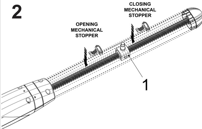
Mantenendo la forcella (1) a metà corsa, inserire gli arresti meccanici come mostrato a lato, avendo cura di far combaciare la filettatura con quella della vite.
