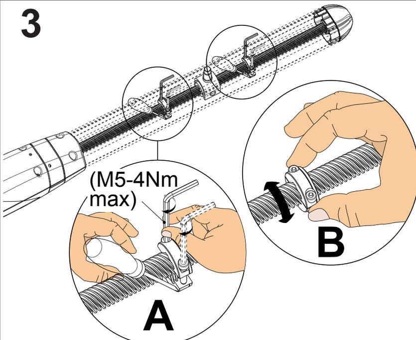
Unire le due metà degli arresti meccanici aiutandosi con un cacciavite (A). Non serrare le viti al massimo per permettere all'arresto meccanico di ruotare sulla vite fino alla posizione desiderata (B).
